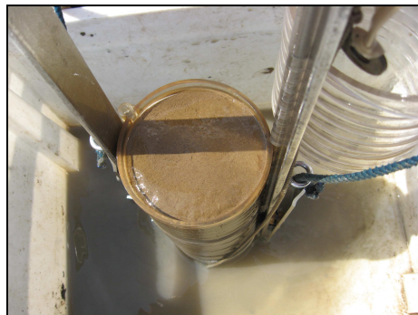
Figur 16. Provtagning av sediment med hjälp av en rörhämtare. Foto: ALcontrol AB.
