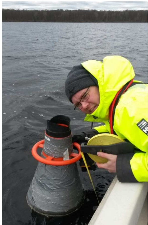
Figur 10. Mätning av siktdjup med vattenkikare och siktskiva. Foto: ALcontrol AB.
