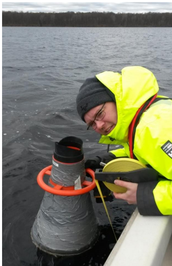
Figur 10. Mätning av siktdjup med vattenkikare och siktskiva. Foto: SYNLAB.
