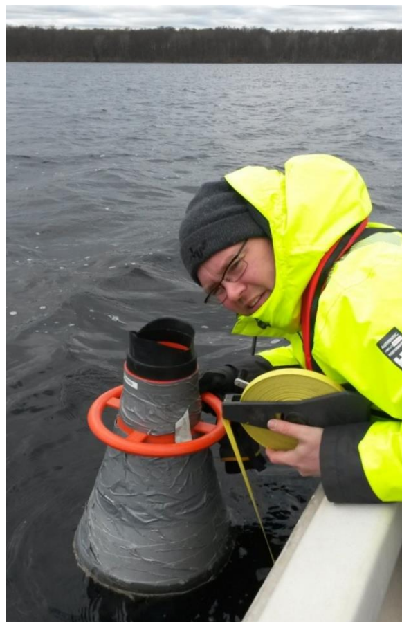
Figur 11. Mätning av siktdjup med vattenkikare och siktskiva. Foto: SGS.
