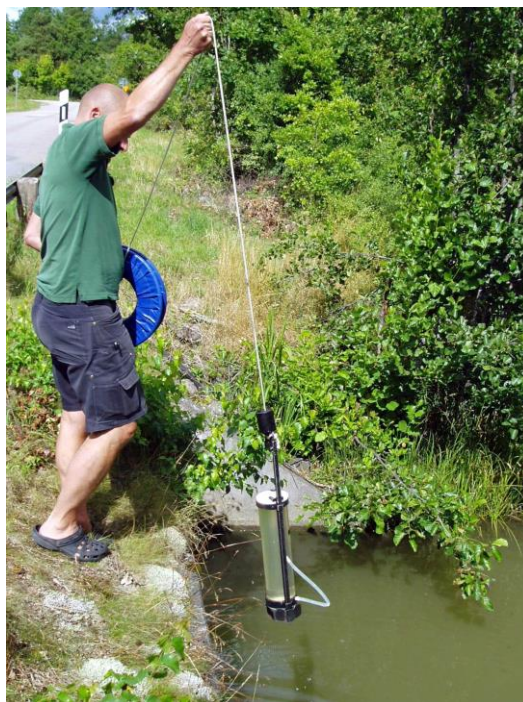
Figur 1. Provtagning med Ruttnerhämtare. Foto: SGS.
