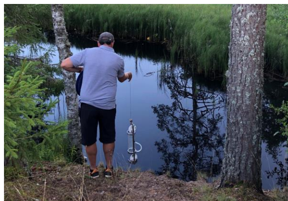
Figur 8. Vattenprovtagning med ruttnerhämtare. Foto SGS.
