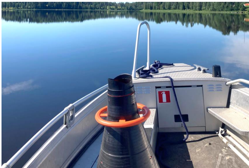
Figur 12. Vattenkikare som används tillsammans med en siktskiva vid mätning av siktdjup. Foto SGS.
