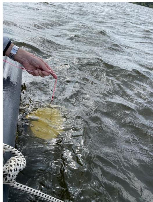
Figur 12. Siktiskiva som används vid mätning av siktdjup. Foto SGS.
