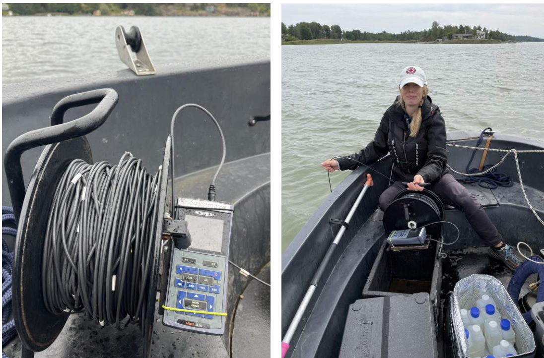
Figur 22. Mätning av temperatur, syrehalt och salthalt. Foto SGS.
