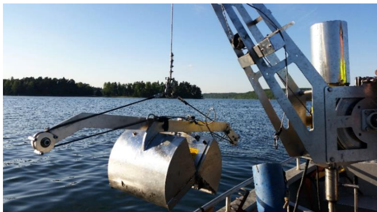
Bild på den typ av van Veen-huggare som användes vid provtagningen.
