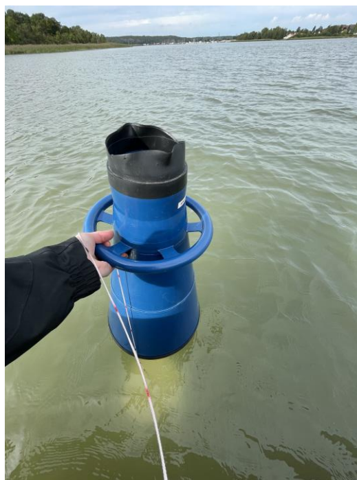
Figur 15. Vattenkikare och siktskiva som används för mätning av siktdjup. Foto SGS.
