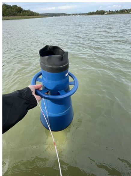
Figur 17. Vattenkikare och siktskiva som används för mätning av siktdjup. Foto SGS.
